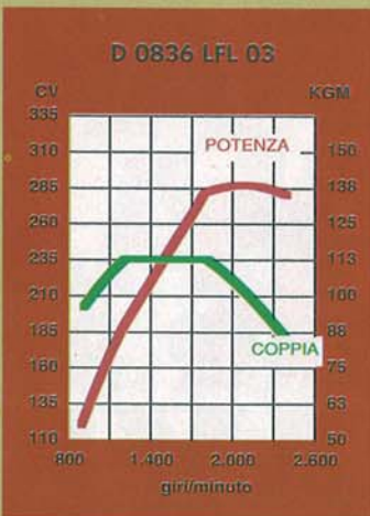
Elaborato da Vado e Torno il grafico è disegnato in modo che le curve di potenza e di coppia si incontrino al regime di rotazione in cui si rileva il minor consumo specifico: 160 grammi per cavallo ora a 2.000 giri.
