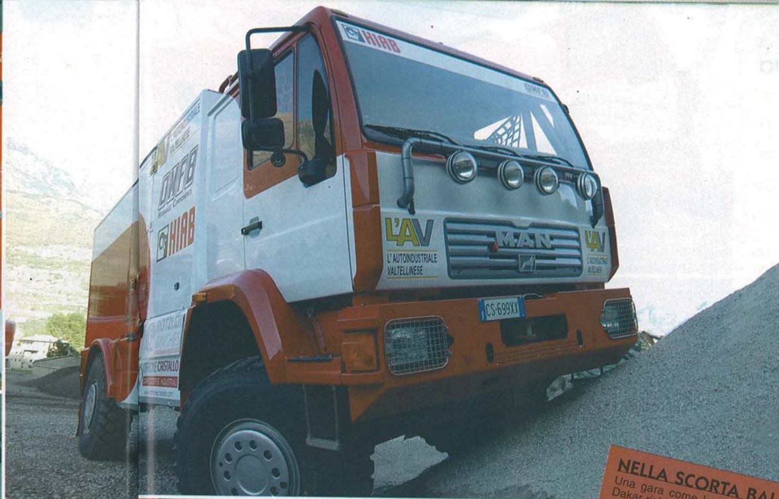
Paraurti in acciaio, griglie ai fari, proiettori sulla calandra: è il frontale del Man per la Dakar. In basso, al centro, la leva del cambio manuale, identico a quello di serie. Modifiche, invece, all'interno (a destra), dove spicca la piastra d'acciaio al pavimento e la strumentazione per la navigazione sul lato passeggero.
