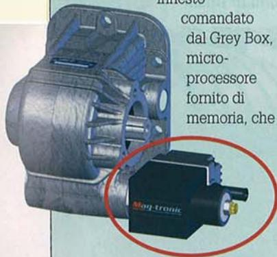
dialoga con la centralina del mezzo. Il Grey Box sovrintende inoltre all'autodiagnosi e "collabora" con l'operatore per la manutenzione.
