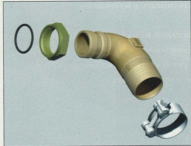
mità lato tubo ha una lavorazione a dente di sega che, unitamente all'impiego di una fascetta stringitubo, impedisce lo sfilamento accidentale.
