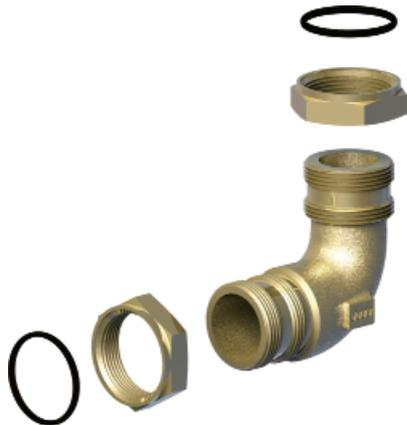
Raccordi angolati a 90° realizzati in ottone fuso, particolarmente indicati per il montaggio e l'orientamento delle saracinesche sui serbatoi. La tenuta è garantita su entrambe le estremità da un OR e da un controdado di bloccaggio.
