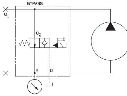
M = attacco manometro/manometer - D = drenaggio/drain
