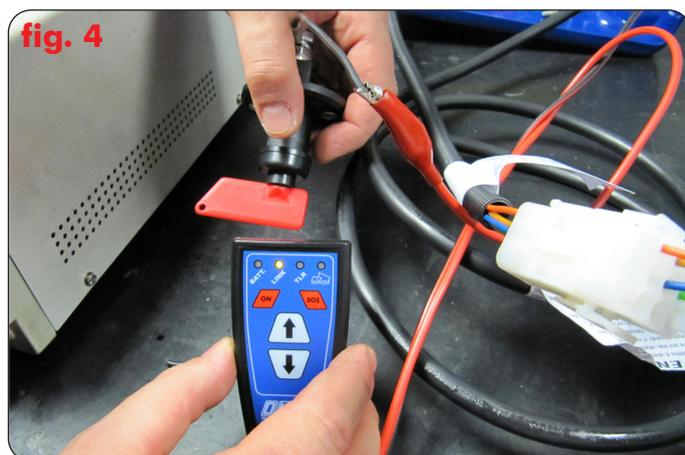
5. Entfernen Sie den elektrischen Leiter der Klemme 1 (siehe Details in Bild 1) von der Empfängerinheit und vom Pluspol des Motorstartschalters.
