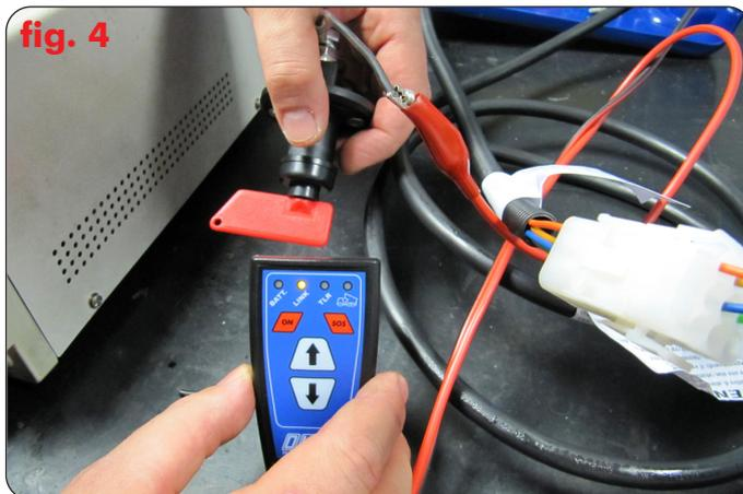
5. Retire el cable eléctrico desde el faston 1 (ver detalle fig. 1) del receptor y desde el positivo en el rele del motor.
