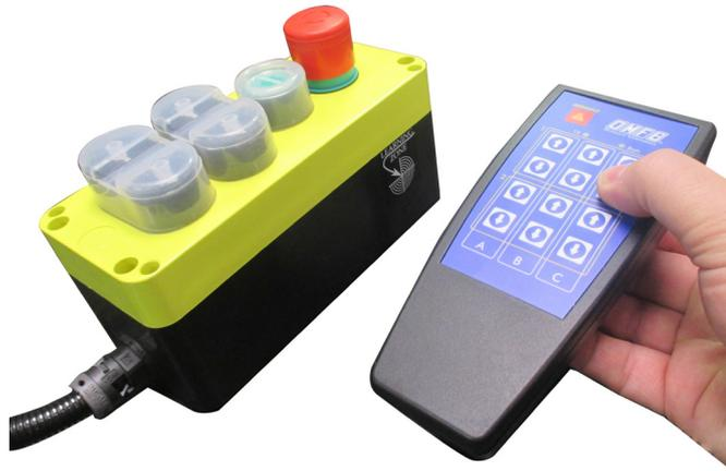
5. Sur l'émetteur : presser une des touches fonction (Lève/Baisse du canal 1 ou Lève/Baisse du canal 2) de la colonne sur laquelle on veut programmer le récepteur (A, B ou C)
