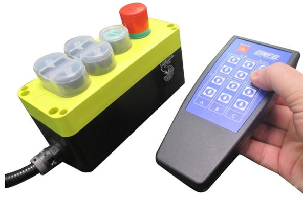
5. Sul trasmettitore: premere uno dei pulsanti funzione (Alza/Abbassa del canale 1 o Alza/Abbassa del canale 2) della colonna su cui si vuol programmare il ricevitore (A, B o C)
