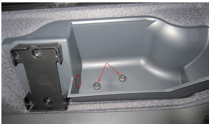
Fissare la piastra di supporto all'interno del vano portaoggetti utilizzando le due viti M 8x35 a testa ribassata, fissare il supporto in plastica alla piastra con le 4 viti a brugola M 6 x 40. Montare il deviatore pneumatico utilizzando i raccordi pneumatici a 90° e le viti autofilettanti inclusi nel kit.
