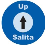
In Konformität zu den geltenden Gesetzesvorschriften ist die Hebesteuerung, sowie alle Bewegungssteuerungen der Pritsche, derart konfiguriert, dass der "Bediener anwesend" sein muss: die Bewegung setzt ein, sobald der Bediener die Drucktaste für Heben drückt und bleibt solange bestehen, wie die Taste gedrückt wird. Sobald der Bediener die Drucktaste für Heben loslässt, unterbricht er die Hebebewegung; gleiches gilt für das Absenken.
