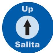
Conformément aux normes en vigueur, la commande Montée ainsi que toutes les commandes de déplacement de benne, est configurée à "Homme-Présent": le mouvement commence quand l'opérateur presse le bouton de montée et continue tant que l'opérateur tient le bouton pressé. Au moment où l'opérateur lâche le bouton le déplacement de montée, comme celui de descente doit s'interrompre.
