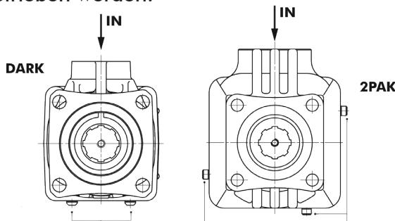
Bitte korrekt Entlüftungsschrauben schließen.
