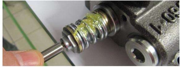
Posizionare il perno snodo (n.6) nell'asola del gruppo perno e procedere all'ingrassamento.
