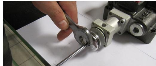
Vincolare con l'ausilio di apposite chiavi il pistone (n.3) al filetto del perno snodo utilizzando la vite (n.14) e la rondella (n.13). Mettere sul filetto della vite del frenafillette forte.
