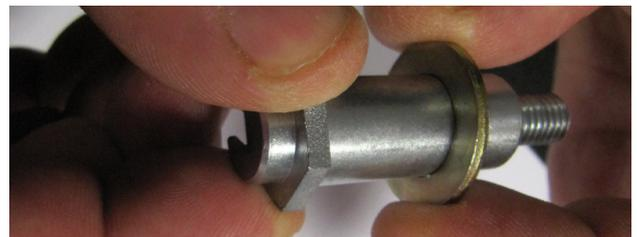
Procedere all'assemblaggio del gruppo perno. Posizionare una rondella (n.12) all'esagono del perno (n.5).
