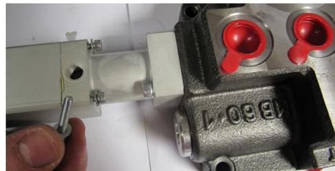
Posizionare il cilindro del comando pneumatico (n.1) facendolo scorrere sul pistone e completare il montaggio utilizzando le quattro viti (n.10) e quattro rondelle (n.11).
