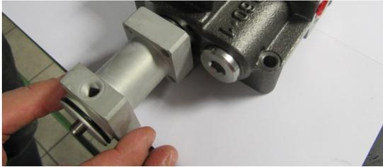
Inserire il corpo comando pneumatico (n.2) al perno snodo facendo attenzione a non danneggiare la guarnizione in teflon.
