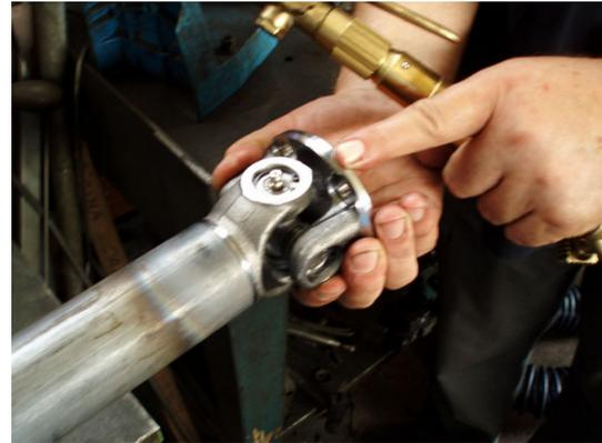
Per tubi con spessore superiore a mm 2,4 scaldare con il cannello (non oltre i 300°C). Rispettare sempre l'allineamento delle forcelle (tolleranza max +/- 1°). Per il controllo allineare due punzoni appoggiati sui cuscinetti. Per saldare, montare la trasmissione su due controflange corrispondenti all'attacco delle flange.
