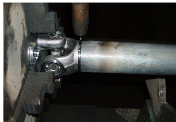
Dopo la saldatura ricontrollare l'eccentricità, con il comparatore e, se necessario, raddrizzare la trasmissione con la pressa.
