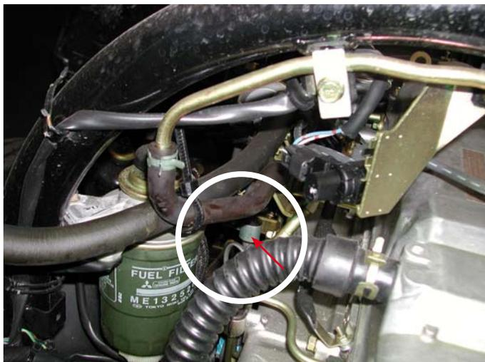
Ubicación aconsejada del grupo de electroválvulas: bastidor o falso bastidor, parte posterior de la cabina.
