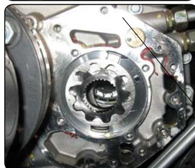
2) Die Getriebefläche sorgfältig reinigen.
