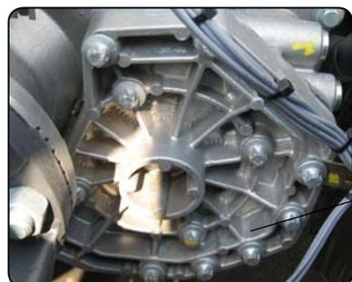
1) Den originalen Deckel des Getriebes entfernen und sicherstellen, dass die Bauteile der Schmierpumpe korrekt im Sitz positioniert sind.
