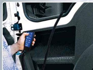
in ESTERNO CABINA: unità di comando estensibile fino a 2,5 metri.
